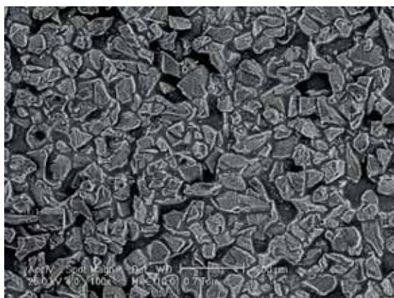
FIGURA 7. Imagini de microscopie electronică de baleiaj – Bracket ceramic Clarity, 3M Unitek la diferite mărimi a) 25x și b) 100x
