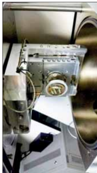
FIGURA 5. Probă pregătită pentru SEM
