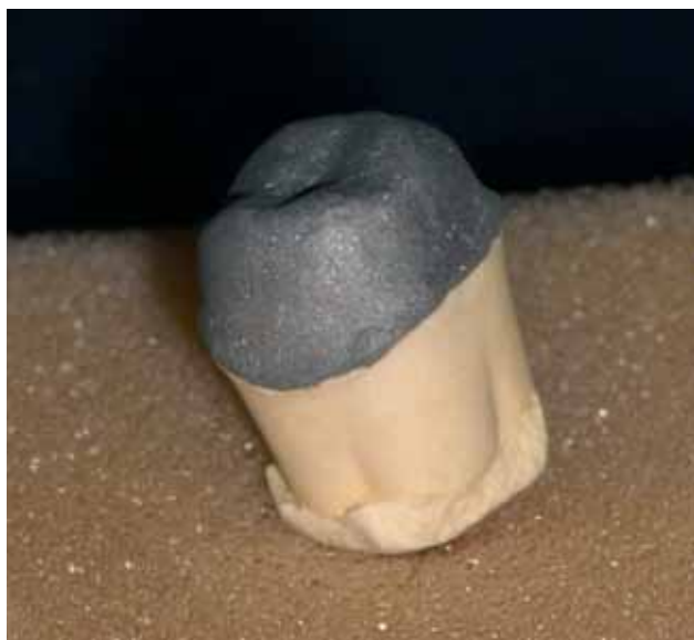
FIGURA 2. Capă metalică din aliaj de Cr-Co obținută prin SLM.
