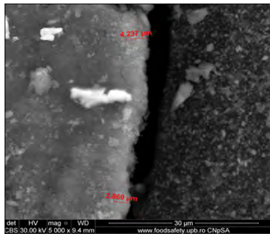
FIGURA 29. Zona de smalț- smalț hibridizat-primer-compozit la mag. 5.000 x, grosimea smalțului hibridizat 3,342-3,593 μm
